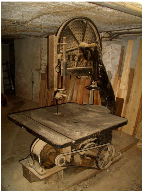
Eine noch betriebsbereite Bandsäge von 1922. Damit beim Kauf der Bandsäge keine Schulden gemacht werden mussten, hat der Vater von Klaus Gemmel, eine Wiese verkauft und mit dem Erlös die Bandsäge gekauft. Hergestellt wurde die Säge im Alsenzwerk, Alsenborn i. d. Pfalz. (Oben: Herstellerschild)
